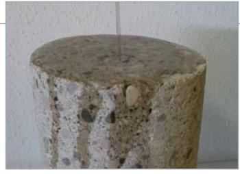
Ohne das drainfähige Polymeradditiv bleibt Wasser auf der Oberfläche stehen und verursacht gefährliches Aquaplaning.
