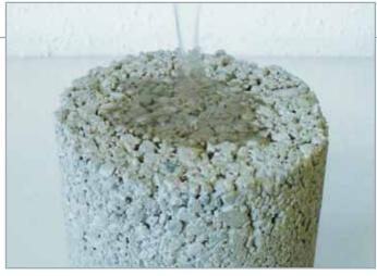
Unter Verwendung von Nanoalps® System DRAIN sickert Wasser in die unteren Schichten und ermöglicht eine trockene Oberfläche.
