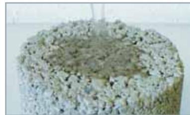
6. Демонстрация водопоглощающей способности готового затвердевшего слоя
